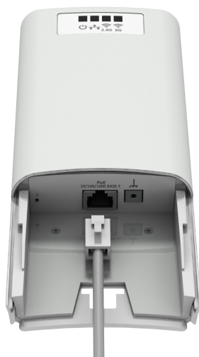
Рисунок 14 — Подключение Ethernet-кабеля к PoE-порту
