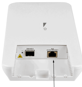
Рисунок 12 – Подключение Ethernet-кабеля к PoE-порту
